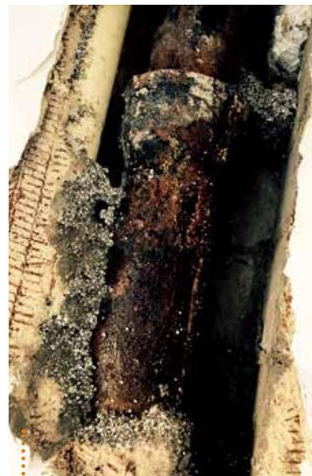
Die Verbindung zwischen zwei Rohren bricht und führt zu „bestimmungswidrig austretendem Wasser“. Decken und Wände müssen aufgestemmt werden, um eine Reparatur durchzuführen.
